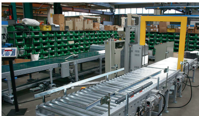
Verpackungslinie mit 0875 & TR200 und Förderer
